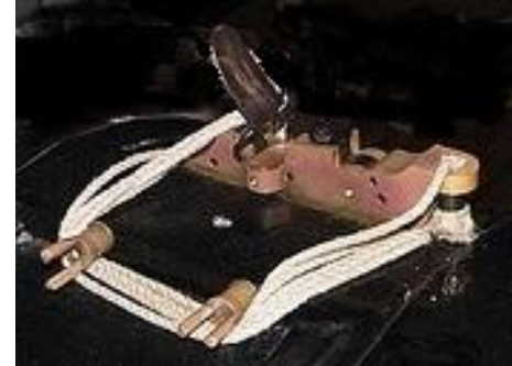
Vuursteenslot gemonteerd met afvuurlijn er omheen gedraaid
